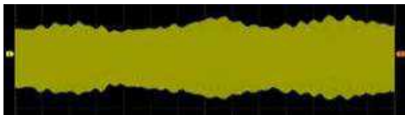
Figura 13 – Semnalul de radiofrecvență captat de antena de ferită
