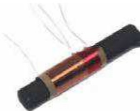
Figura 5 – Antena cu ferită
